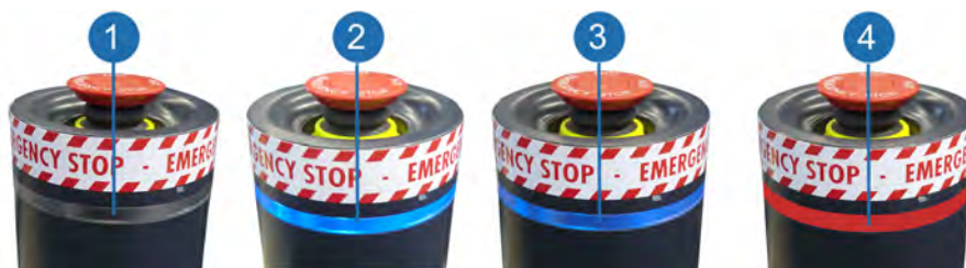
Рис. 16: Индикатор состояния лазера на колонке монитора
