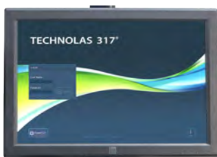
Рис. 35: Панель управления хирурга (состоит из монитора с сенсорным экраном и клавиатуры)
