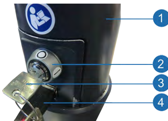
Рис. 15: Блокируемый ключом переключатель «On/Off» и системный ключ
