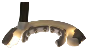
Рис. 36: 2 светодиода сбоку на модуле системы откачивания
