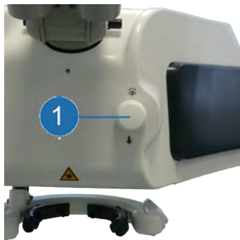
Рис. 22: Расположение ручки для перемещения и регулирования толщины световой щели (1)
